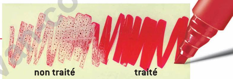
Ce procédé permet donc de localiser l'énergie superficielle à l'aide de deux épreuves et de déterminer que l'énergie superficielle du matériel testé présente p. ex. une valeur entre 36 et 38 mN/m.
